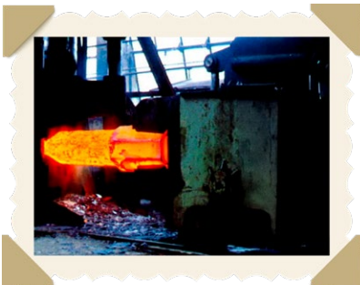
Ausschmieden eines 8.000-kg-Blocks zu einer Welle – Schmiedepresse mit 10.000 kN Presskraft.
