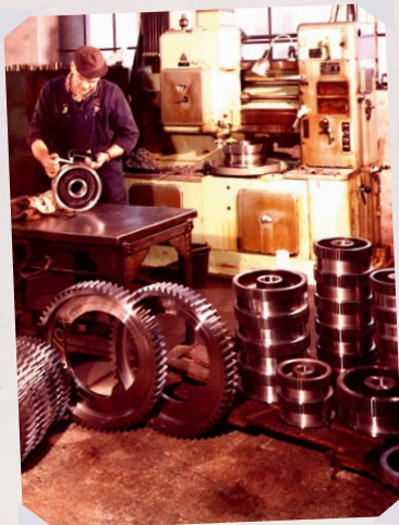
Stoßverzahnung von Kranlaufrädern und anschließendes Vermessen.
