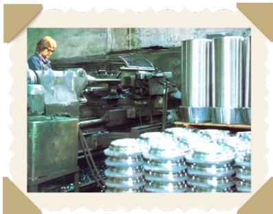
Überdrehen und Ausdrehen von Bauteilen für automatische Mittelpufferkupplungen.
