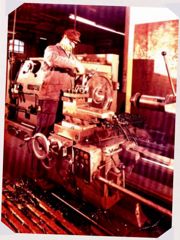
Drehmaschine für die Bearbeitung von Kranlaufrädern.
