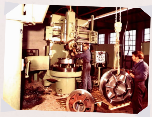
Karusselldrehmaschine für die Bearbeitung von größeren Kranlaufrädern.
