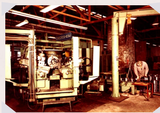
Spindeldrehautomat Multifront mit drei Stationen zur kompletten Bearbeitung eines Laufrades.
