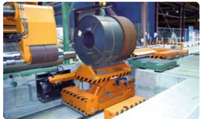
剪式升降台，由轮箱系统 ATLAS 承担 通用、现代、模块化且耐久。
