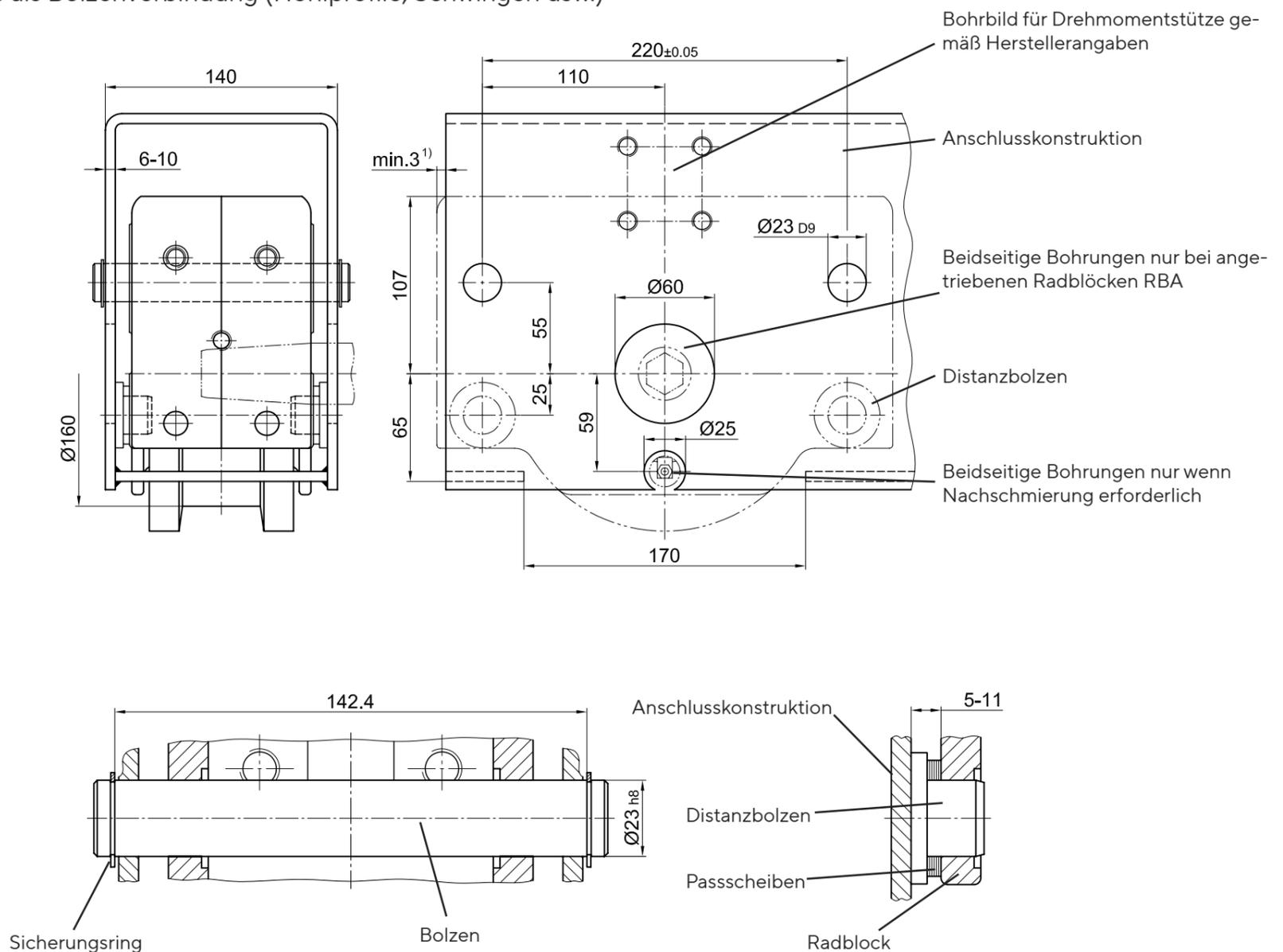
1 Satz Befestigungselemente für Bolzenanschluss BA 160.1 besteht aus:
