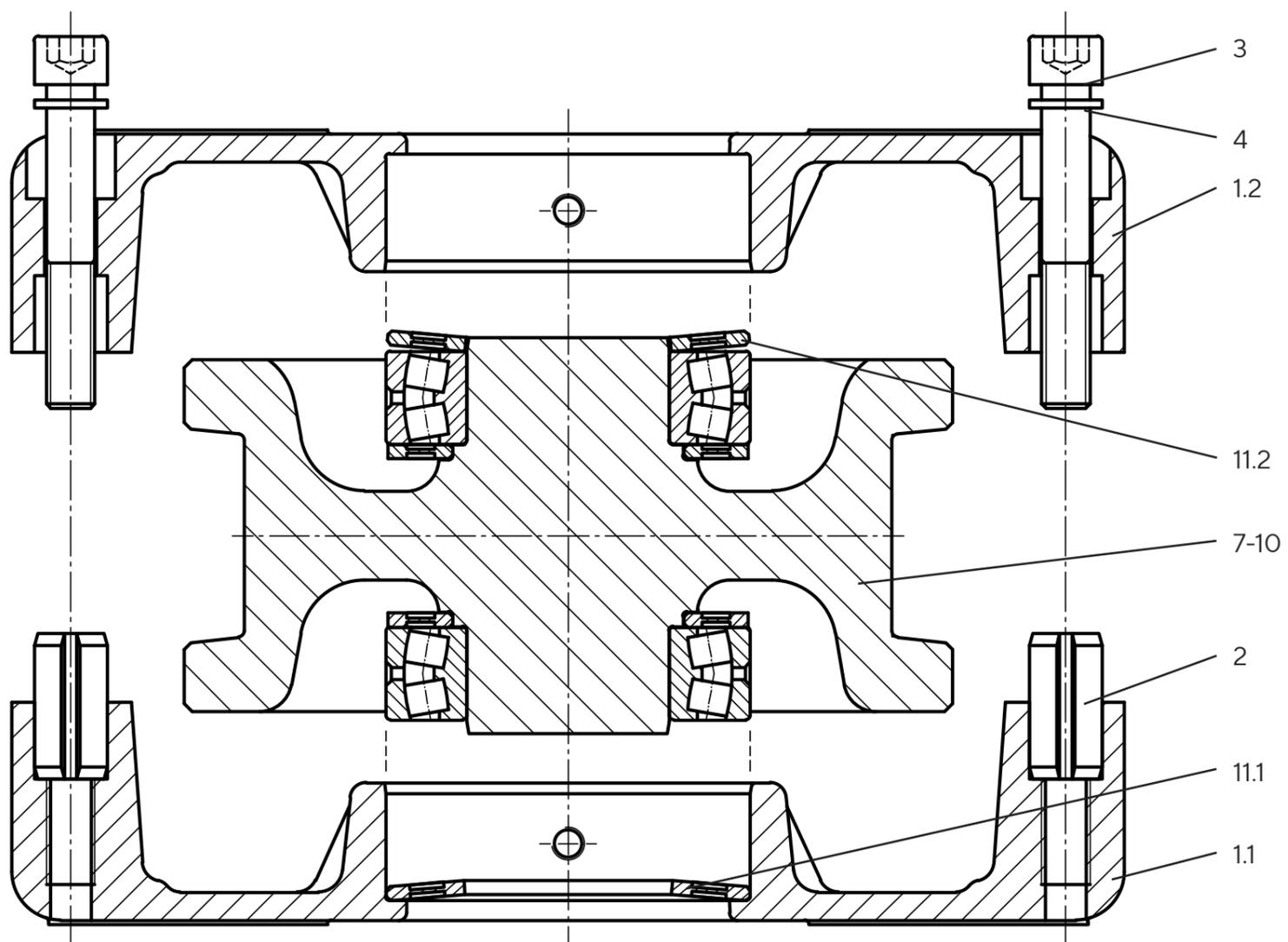
Die Radblöcke mit Spezialabdichtung bzw. für höhere Temperaturen und/oder ATEX werden wie vorher beschrieben montiert, jedoch anstatt der Kunststoffdichtscheiben werden Nilosringe (Metalldichtungen) und Schutzscheiben aus Stahl (Teil 16-19) eingebaut.
