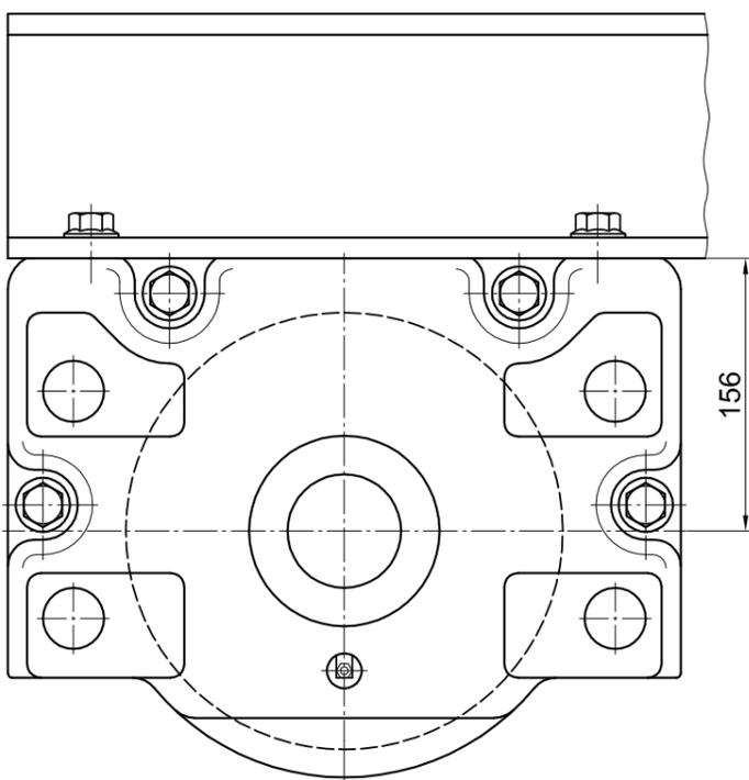
Patrón de perforaciones de la estructura de conexión para la variante de ajuste de precisión
