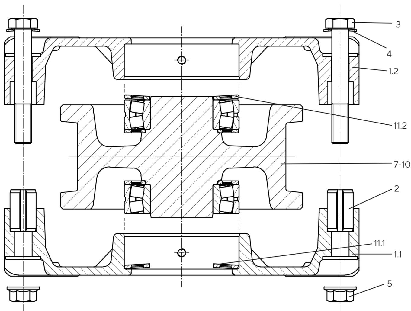
Los bloques de rueda con hermetizado especial o para altas temperaturas y/o ATEX se montan tal y como se ha descrito anteriormente. No obstante, en lugar de arandelas de junta de plástico, se montan anillos Nilos (juntas de metal) y arandelas de protección de acero (pieza 16-19).
