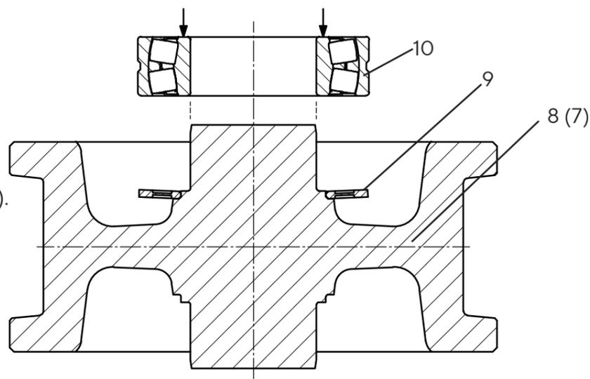
4. Darle la vuelta a la rueda y proseguir el montaje en el otro lado del cubo, tal y como se describe en los puntos 2. y 3.
