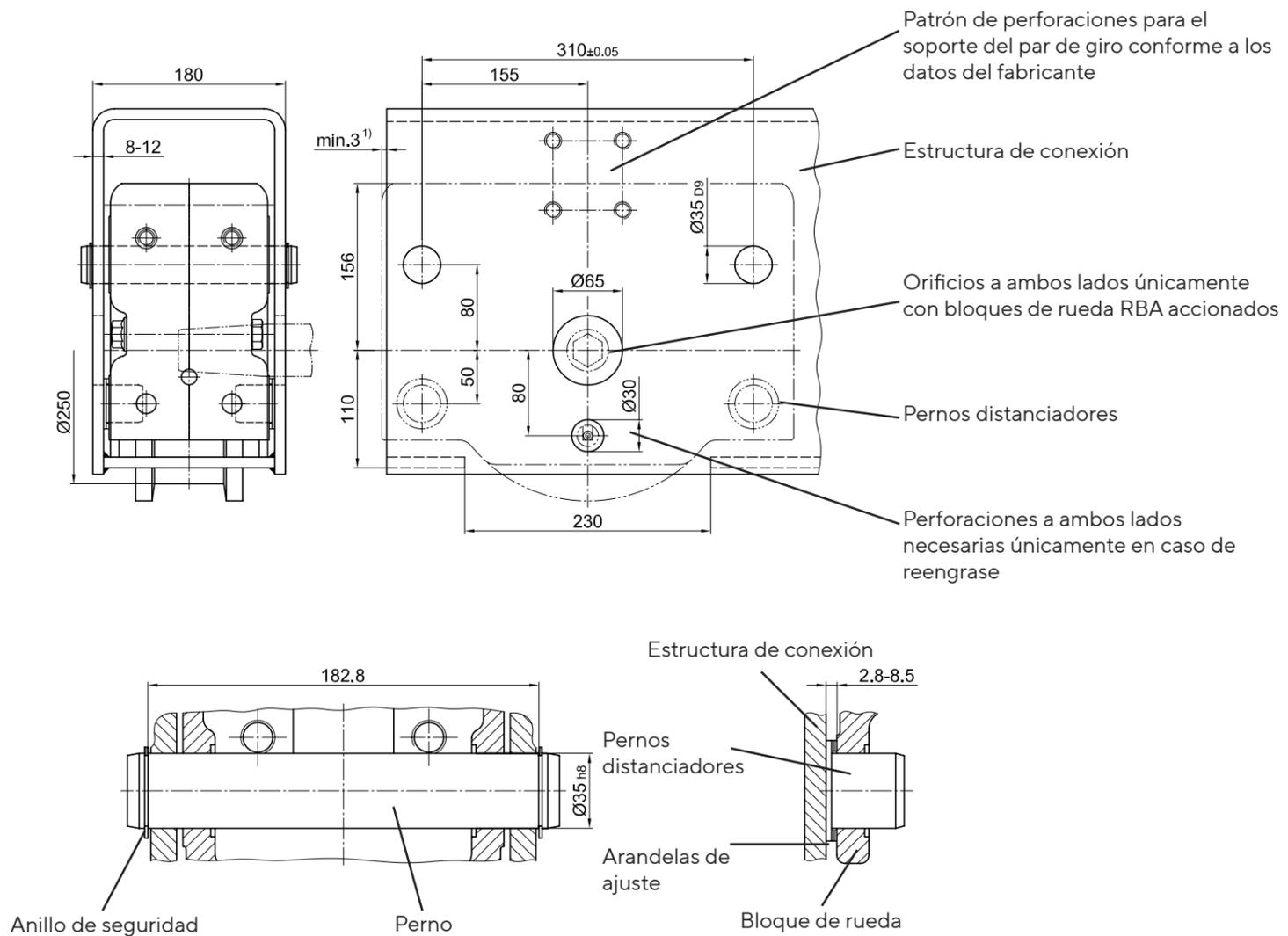
1 juego de elementos de fijación para la conexión de perno BA 250.1 compuesto de:
