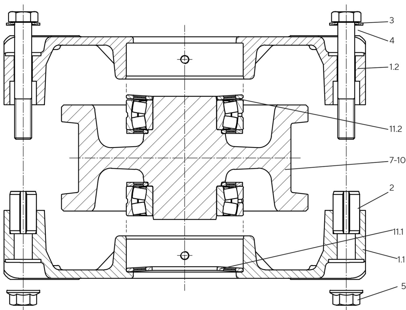
Los bloques de rueda con hermetizado especial o para altas temperaturas y/o ATEX se montan tal y como se ha descrito anteriormente. No obstante, en lugar de arandelas de junta de plástico, se montan anillos Nilos (juntas de metal) y arandelas de protección de acero (pieza 16-19).
